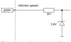
Figure 13 «Monitor speed» – Output circuitry
