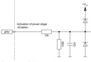
Figure 11 «Enable» – Input circuitry
