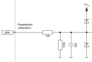
Figure 12 «Direction» – Input circuitry
